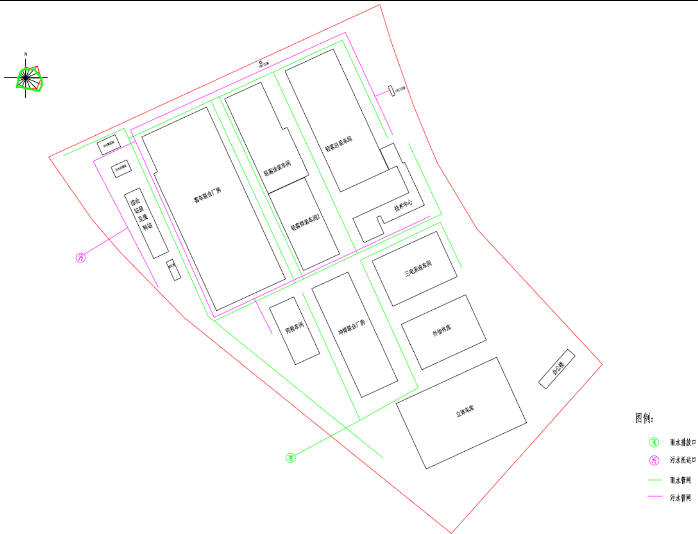
图 3.1-5 雨水、污水管网图
